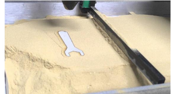
Sinterizado, la pieza solidificada (llave de tuerca) junto con polvo metálico no sinterizado.
