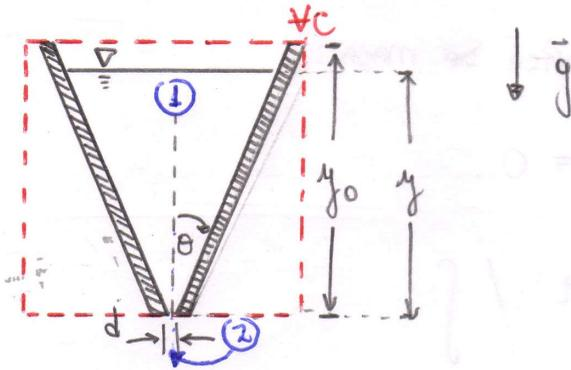
Para este problema, utilizaremos el volumen de control especificado. En base a ese volumen de control, se realiza un balance de masa según la ecuación:
