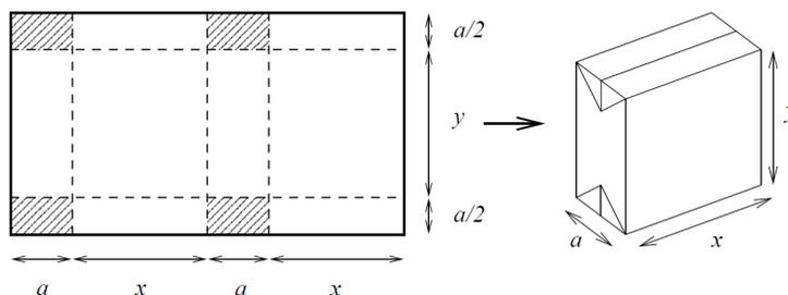
Se desean determinar las dimensiones óptimas  $a, x, y$  que minimicen la superficie del rectángulo original para un volumen total de 1000 (un litro)
