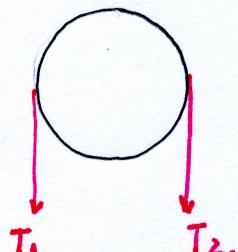
Tenemos que de las ecuaciones de fuerza se obtienen las variables  $T_1, T_2, a_1$ : Aceleración de la maseta y  $a_2$ : Ac. de  $M_2$ . Ademas, de la sumatoria de torques se tiene  $\alpha$ : Aceleración angular de la polea.
