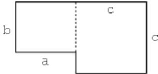
**P2.** Encuentre la posición del centro de masas de un disco de densidad superficial  $U$  y que tiene un agujero circular como se indica en la figura adjunta.
