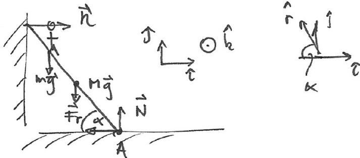
Tomando torque en torno al punto  $A$  en la figura, dado que la pared no tiene roce, la reacción  $\vec{R}$  es perpendicular a la pared:
