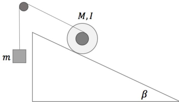
**P3.** Considere un cilindro macizo y homogéneo de 30 cm de diámetro colocado sobre un plano inclinado  $25^\circ$ . ¿Cuál es el valor mínimo del coeficiente de rozamiento para que el cilindro descienda rodando sin deslizar? ¿Cuál es su aceleración angular?
