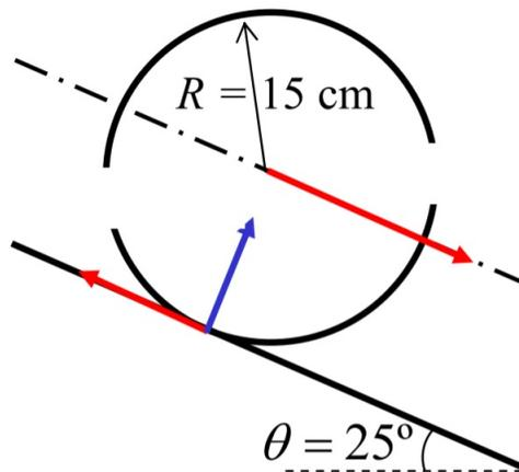
**P4.** Se tiene un disco en un plano inclinado con un ángulo  $\theta$  que rueda sin resbalar. Encuentre la expresión de energía cinética generalizada. Considere el disco de masa  $M$ , radio  $R$  y momento de inercia  $I$  e  $I_g$ .
