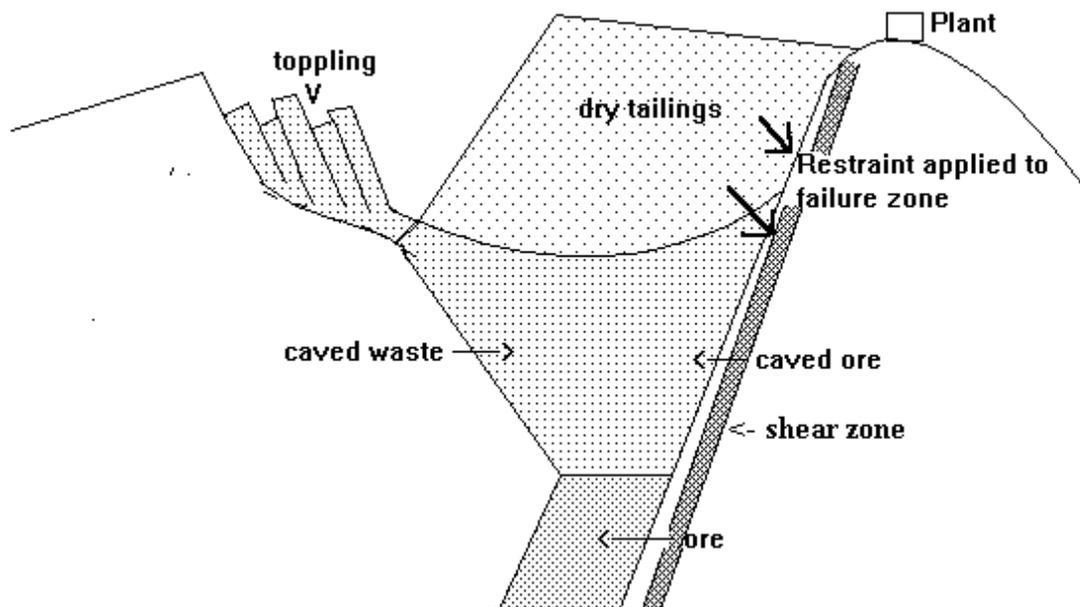
**STABILISING THE FOOTWALL BY DUMPING DRY TAILINGS**
