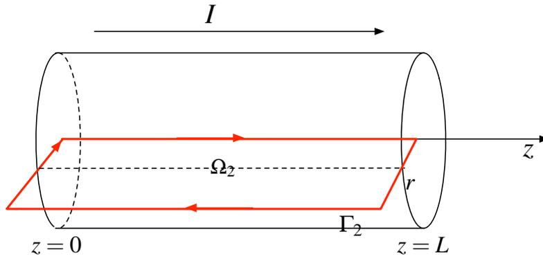
Figura 12.2: Superficie y camino de integración para  $r \geq R$ Solución 12.2 P ✓
