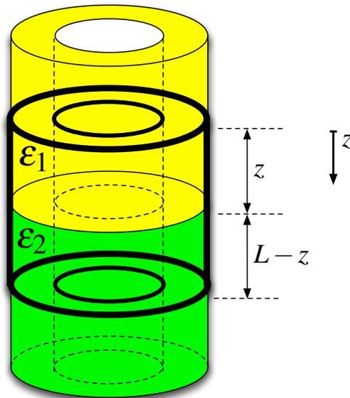
Figura 17.1: Dieléctricos dentro del Condensador Cilíndrico
