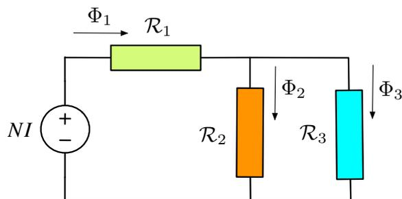
Figura 18.2: Circuito Equivalente.
