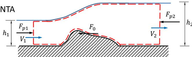
Como las líneas de corriente a la entrada y salida del volumen de control son paralelas, la distribución de presiones es la hidrostática. Si  $b$  es el ancho del canal:
