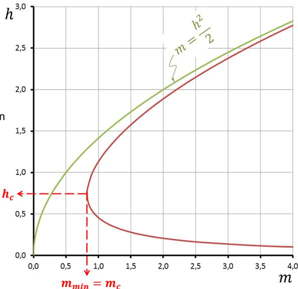
Notar que la altura para la cual se tiene momenta mínima coincide con la altura para la cual se tiene energía mínima sólo si  $\alpha = \beta = 1$ .
