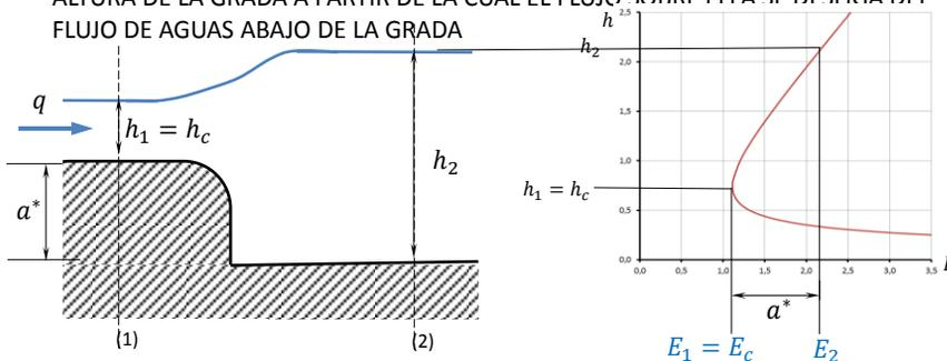
Existe un valor límite de la altura de la grada,  $a^*$ , a partir de la cual la altura en la sección (1) es la altura crítica:  $h_1 = h_c$  para  $a \geq a^*$ .
