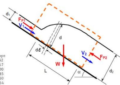
Para el rango  $2,9 < Fr_1 < 17,9$  la longitud del resalto puede estimarse de:
