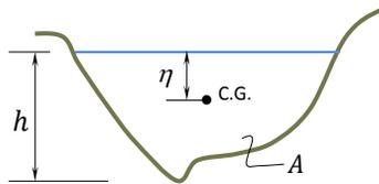
Consideremos un canal prismático, horizontal y apliquemos el teorema de la cantidad de movimiento entre dos secciones en las cuales tengamos líneas de corriente paralelas (o cuasi-paralelas). Para la componente en la dirección del flujo:
