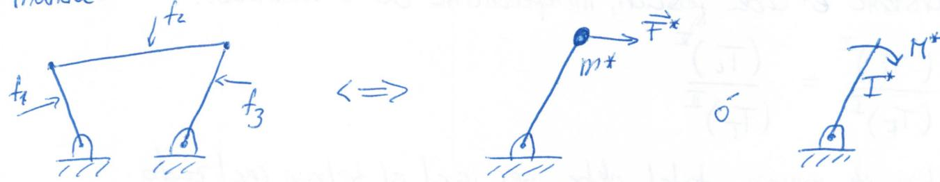
Para realizar esto, hay que escribir la energía cinética del mecanismo en función de una coordenada generalizada.
