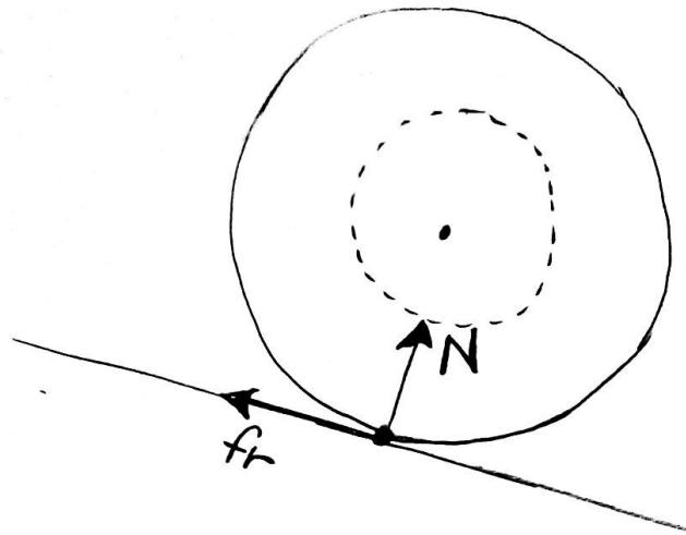
Si se calcula el torque con respecto al punto de apoyo, tanto la normal como el radio tendrán torque nulo.
