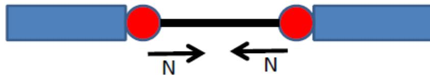
Solo transmite Esfuerzo Axial
