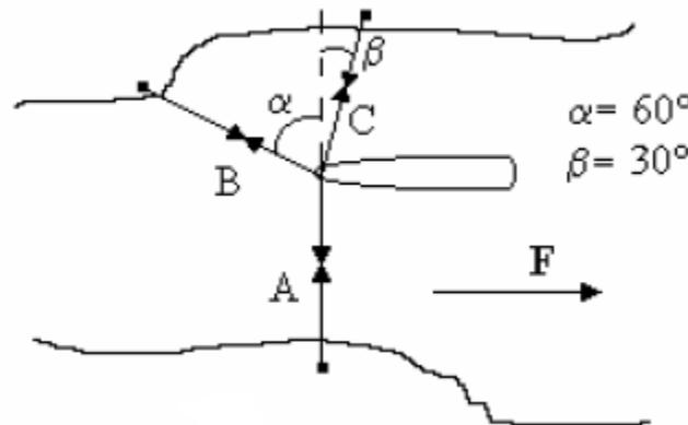
3- Una masa de 200 kg cuelga de dos cables que están sujetos a la parte superior de una pared vertical como se indica en la figura. Si la fuerza  $F$  (perpendicular a la pared) sostiene esta masa en equilibrio, hallar el módulo de la fuerza  $F$  y la tensión (fuerza) en cada cable.
