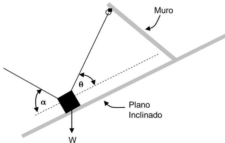
En este caso la manera más sencilla de resolver el problema será descomponer todas las fuerzas en un eje paralelo al plano inclinado y otro perpendicular a él. Así por ejemplo la fuerza del cable derecho se descompondrá como sigue:
