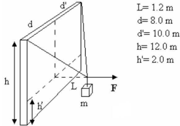
4- En la figura siguiente se muestra una conexión a la cual concurren tres elementos estructurales. Determinar, mediante la descomposición de las fuerzas, la magnitud la dirección y el sentido de la fuerza resultante (suponga que las tres fuerzas concurren a un mismo punto).
