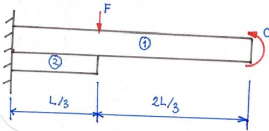
**P2.-** La viga compuesta en voladizo está sometida a una fuerza puntual  $F$  y a un momento puro  $C$  en el extremo derecho. La viga está hecha de dos materiales, cuyas secciones se muestran en la parte inferior de la figura. Estos dos materiales están perfectamente pegados.
