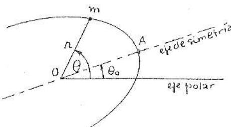
Calculemos la componente radial  $\dot{r}$  de la velocidad con que pasa la partícula por el punto A en que su trayectoria corta al eje de simetría. Este punto corresponde al ángulo  $\theta = \theta_0$ .
