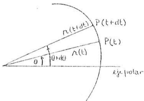
De la figura, donde  $P(t)$  y  $P(t+dt)$  son dos posiciones infinitesimalmente próximas de la partícula sobre su trayectoria, se tiene que el área barrida por el radio vector en un  $dt$  de tiempo es:
