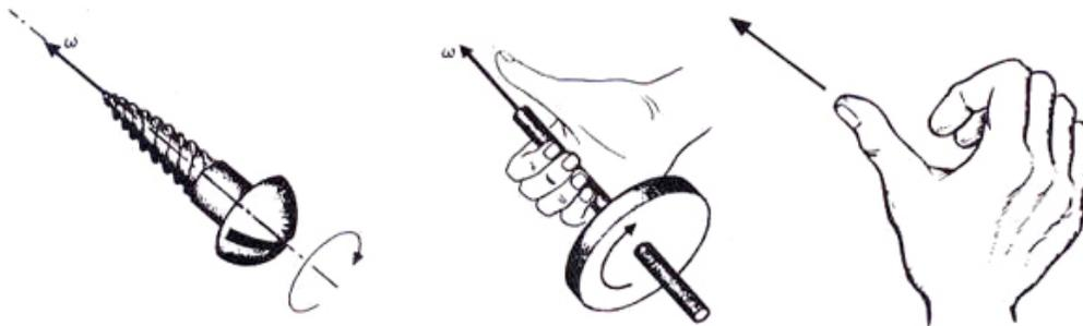
Figura XI.2: Uso de la regla de la mano derecha. Es una convención usada frecuentemente y por lo tanto conviene no olvidar. Entre sus aplicaciones permite asociar un vector a la velocidad angular  $\omega$ .
