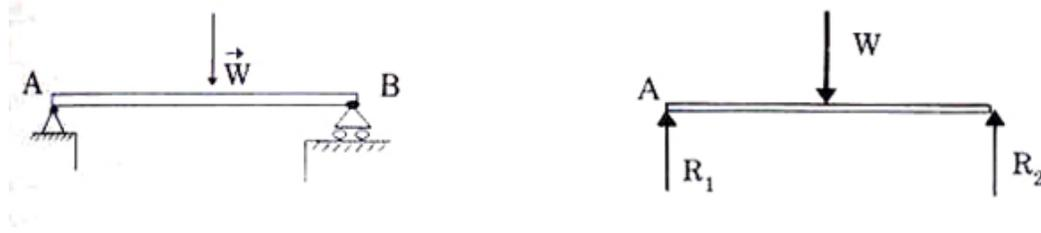
Figura XI.11: Modelo de la viga soportada en sus extremos por una unión fija y otra deslizante. A la derecha se incluye el diagrama de cuerpo libre de la estructura.
