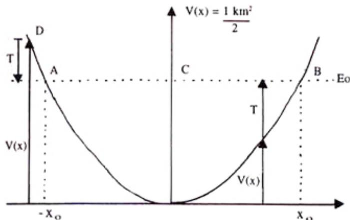
Figura IX.6: Por convención la flecha de la energía cinética siempre debe apuntar en el sentido positivo de la ordenada  $V(x)$ . La energía potencial puede ser positiva o negativa.
