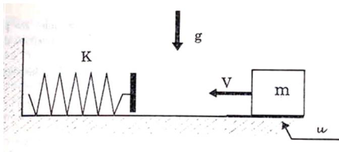
Figura IX.7: El resorte está inicialmente con su largo natural y la masa  $m$  se acerca con velocidad  $V$ . La energía no se conserva debido a la existencia de roce entre el piso y la masa. La energía disipada es igual al trabajo que realiza la fuerza de roce.
