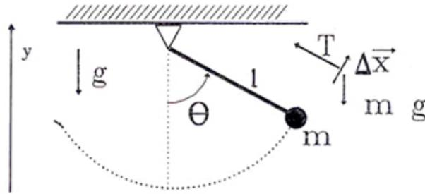
Figura IX.8: En el movimiento del péndulo la tensión no realiza trabajo. Sólo la componente vertical del desplazamiento lo hace debido a la fuerza gravitacional.
