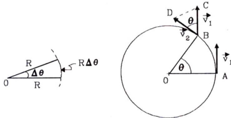
Figura V.30: Se ilustra en forma geométrica la aceleración centrípeta en el movimiento circunferencial uniforme. El ángulo  $\theta$  se supone pequeño, a pesar que aparece aquí exagerado para no agrupar demasiado las componentes de la Figura.
