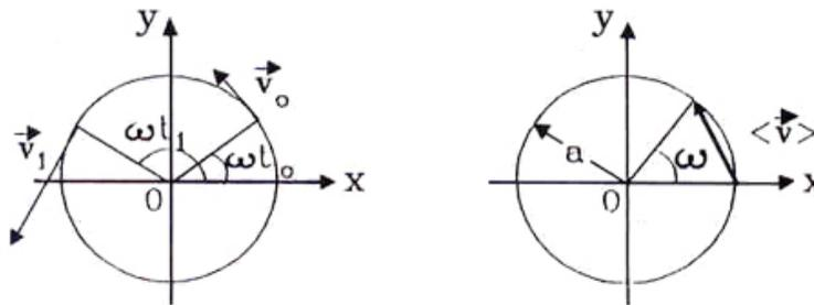
Figura V.25: El traslado a lo largo de una circunferencia es un caso particular de un movimiento en dos dimensiones. A la derecha se indica el vector velocidad promedio entre los instantes  $t = 0$  y  $t = 1$ .
