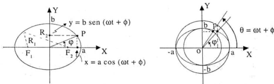
Figura V.43: La suma de  $R_1$  y  $R_2$  es la misma para cualquier punto de la elipse. Los valores  $a$  y  $b$  son los semiejes de la elipse. Se indica el significado del ángulo  $\theta = \omega t + \phi$  y  $\phi$ . Este último señala la posición de la partícula P.
