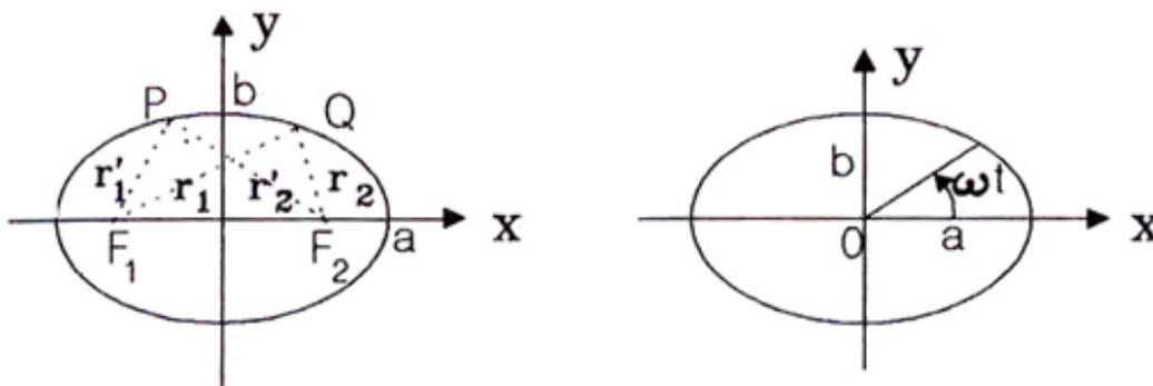
Figura V.42: La definición de la distancia focal y los semiejes  $a$  y  $b$  aparece indicada en el diagrama. Para diferenciar este ejemplo del anterior, supondremos que una partícula viaja a lo largo de esta elipse y que demora un tiempo  $T$  en completar una vuelta alrededor de la elipse.
