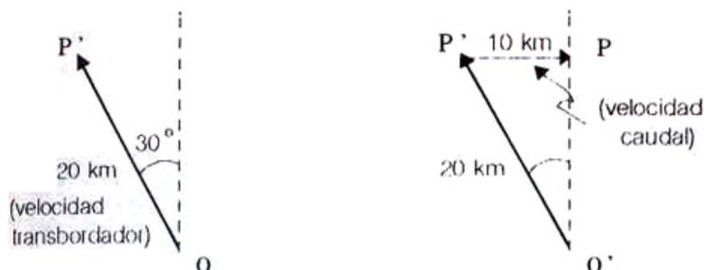
Figura V.12: *Superposición de los movimientos del caudal y del barco. Hemos supuesto que el movimiento en una de las direcciones no afecta en absoluto al movimiento que se realiza simultáneamente en la dirección perpendicular.*
