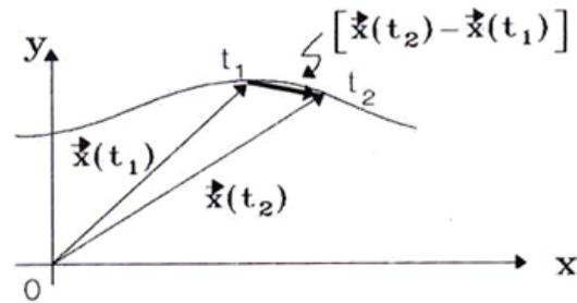
Figura V.9: El vector velocidad es la flecha que une los puntos señalados por  $t_1$  y  $t_2$ . En el límite en que estos dos puntos se acercan hasta converger tanto como se pueda sin poner uno encima del otro. La velocidad instantánea corresponde a la tangente a la curva en dicho punto.
