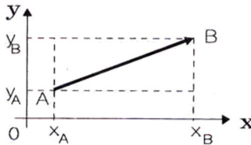
Figura V.3: El origen de un vector no se ubica necesariamente en el origen del sistema de referencia. La Figura representa al vector  $\vec{AB}$ , indicando sus componentes que, como se señaló, corresponden a la diferencia entre la coordenada del punto final menos la coordenada de la cola de la flecha.
