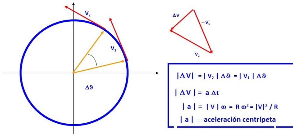
Figura V.31: Resumen geométrico del movimiento circular uniforme.
