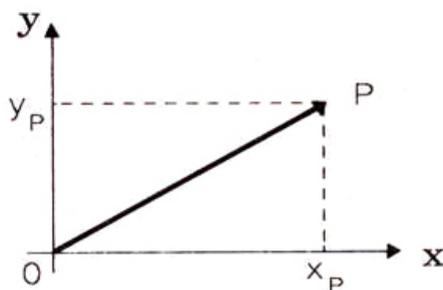
Figura V.1: La flecha  $\vec{OP}$  indica que el objeto se comporta como un vector. Las componentes de este vector, son las proyecciones del vector sobre el eje **x**, denominado **abcisa** y el eje **y**, la **ordenada**. Las coordenadas del punto **P** se escriben como un par ordenado de números reales,  $(x_P, y_P)$ . El primer número,  $x_P$ , se obtiene trazando una paralela al eje **y** a través del punto **P**.
