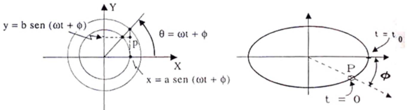
Figura V.44: El ángulo  $\phi$  indica la posición de la partícula en la elipse en el instante  $t=0$
