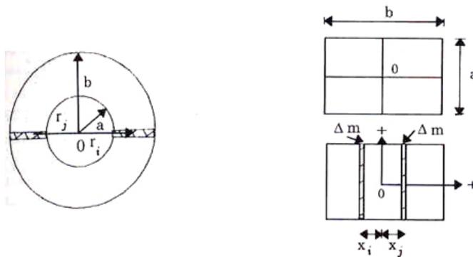
Figura XI.3: Usando las simetrías de cada uno de los dos cuerpos continuos que se incluyen, se puede obtener la posición del centro de masa de ellos, directamente sin tener que calcular explícitamente.
