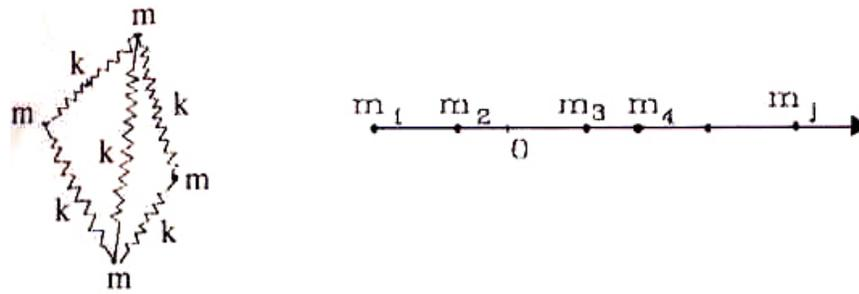
Figura XI.2: Modelo de un sólido unidimensional: masas unidas con resortes (derecha). Un enrejado de resortes, en tres dimensiones, fue utilizado como un modelo de un sólido para para estudiar las propiedades elásticas de un sólido.
