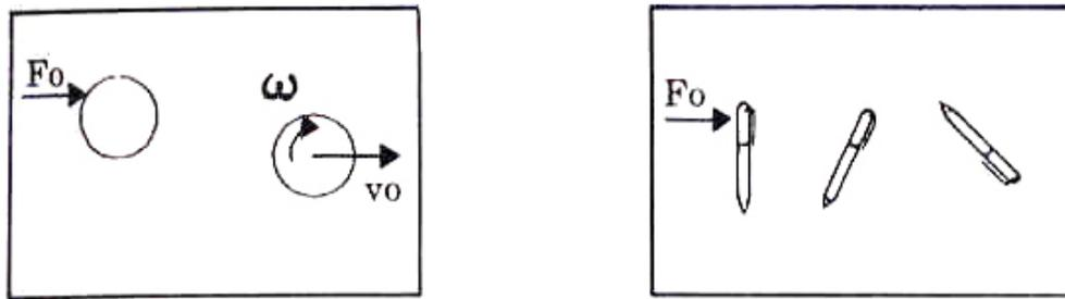
Figura XI.1: Al aplicar una fuerza en una dirección que no atraviesa el centro de masa de un cuerpo, se produce un efecto de traslación y otro de rotación.
