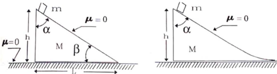
Figura XI.6: Los ángulos de la cuña son  $\alpha$  y  $\beta$ . No existe roce en ninguna de las superficies de contacto, incluyendo el piso. A la derecha, se ha suavizado el ángulo  $\beta$  de manera que la masa  $m$  tenga, al tocar el piso, sólo una componente horizontal para la velocidad.
