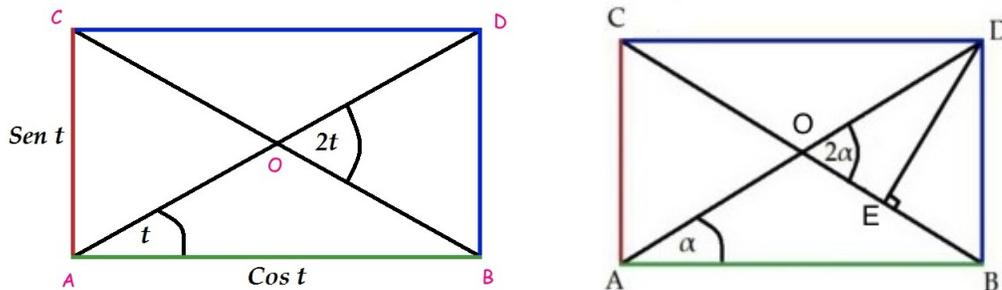
Figura I.20: Se obtiene una expresión para el ángulo doble comparando el área de los dos triángulos congruentes generados en este rectángulo. Note que la diagonal es la unidad y la longitud de los lados es  $\sin t$  y  $\cos t$ .
