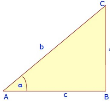
Figura I.16: *Definiciones trigonométricas a partir de un triángulo rectángulo cualquiera. Como uno de los ángulos mide  $90^\circ$  ninguno de los dos restantes puede ser mayor que  $90^\circ$ . Es una restricción que será superada con una definición más general en los siguientes párrafos.*
