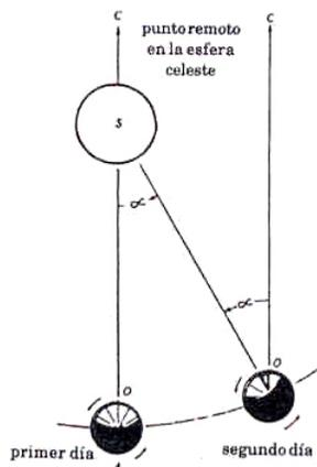
La diferencia que existe entre ambas definiciones se debe al movimiento de traslación de la Tierra alrededor del Sol como se indica en la Figura que se acompaña.
