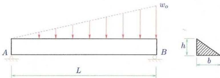
**P3.-** Determine la distribución de esfuerzo de corte causado por la fuerza interna de corte en la viga de la figura. La sección de la viga es mostrada en el lado derecho
