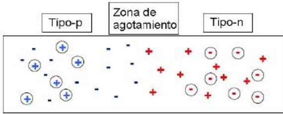
Un diodo semiconductor es un dispositivo conformado por dos semiconductores extrínsecos, uno tipo n y otro tipo p, los cuales se ponen en contacto. Esto determina tres partes principales en el diodo:
