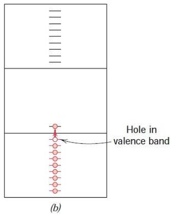
En un semiconductor tipo p, se genera un estado aceptor  $E_a$  cerca de la banda de valencia. Luego, un electrón de esta banda es capaz de saltar fácilmente al estado aceptor, dejando un hueco en la banda de valencia
