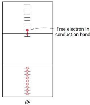
En un semiconductor tipo n, se genera un estado donador de energía  $E_d$  cerca de la banda de conducción cuyo electrón es capaz de saltar con facilidad a la ésta.
