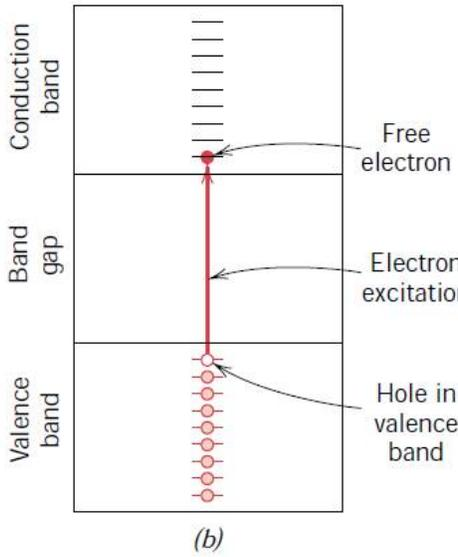
En un semiconductor intrínseco, un electrón en la banda de valencia debe saltar hacia la banda de conducción, y para ello debe recibir una excitación energía igual o superior al band gap
