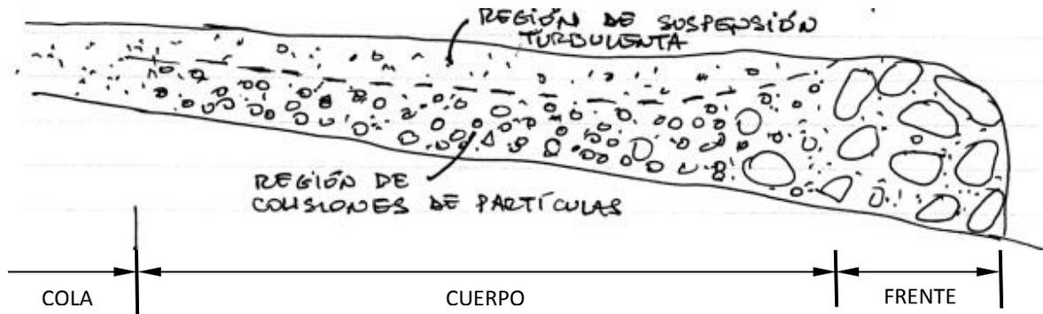
FIG. 2: PERFIL ESQUEMÁTICO DE UNA CORRIENTE DETRÍTICA.
