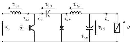
**Figura 1.** Convertidor DC-DC Cúk.
