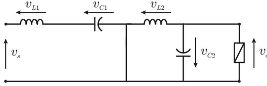
**Figura 3.** Convertidor DC-DC Cúk:  $S_1 = 0$
