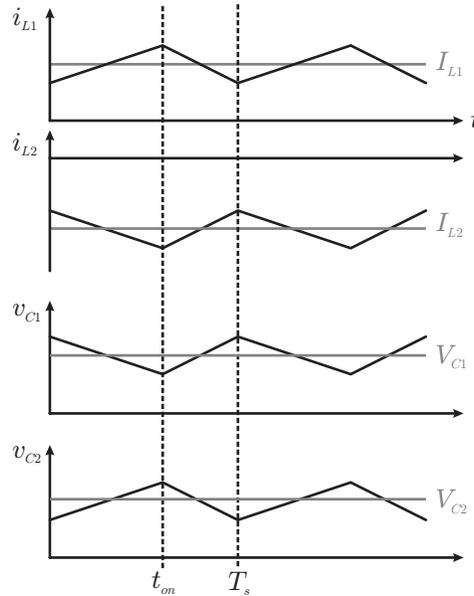
Figura 4. Convertidor DC-DC Cúk: formas de onda
