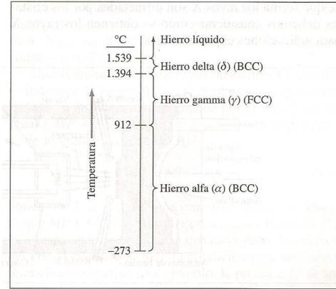
Fig. 3 Estructuras cristalinas del  $Fe$  puro.
