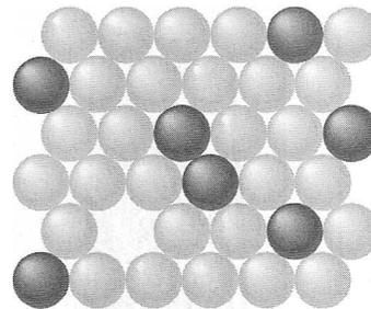
Fig. 1 Solución sólida de sustitución
