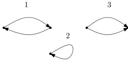
Figura 9: (1) Arcos antiparalelos, (2) un loop y (3) arcos paralelos.
