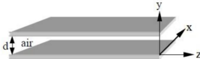
Figura 3 Guía de onda de placas paralelas
