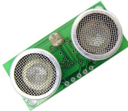
Figura 4: Sensor de ultrasonido.
