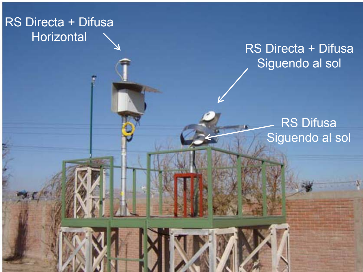
Figura 1: Vista completa de la estación
