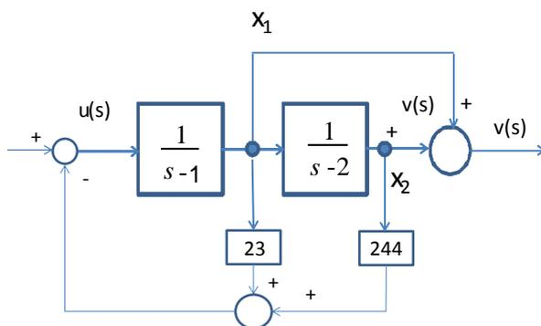
c) Se requiere control integral de la salida  $v(s)$  para seguir con cero error en estado estacionario una señal  $r^*(s)$ . Explique las modificaciones necesarias a las matrices de a) y establezca cuáles son las nuevas matrices  $A$ ,  $B$  y  $C$  necesarias. ¿Es el sistema controlable ahora?
