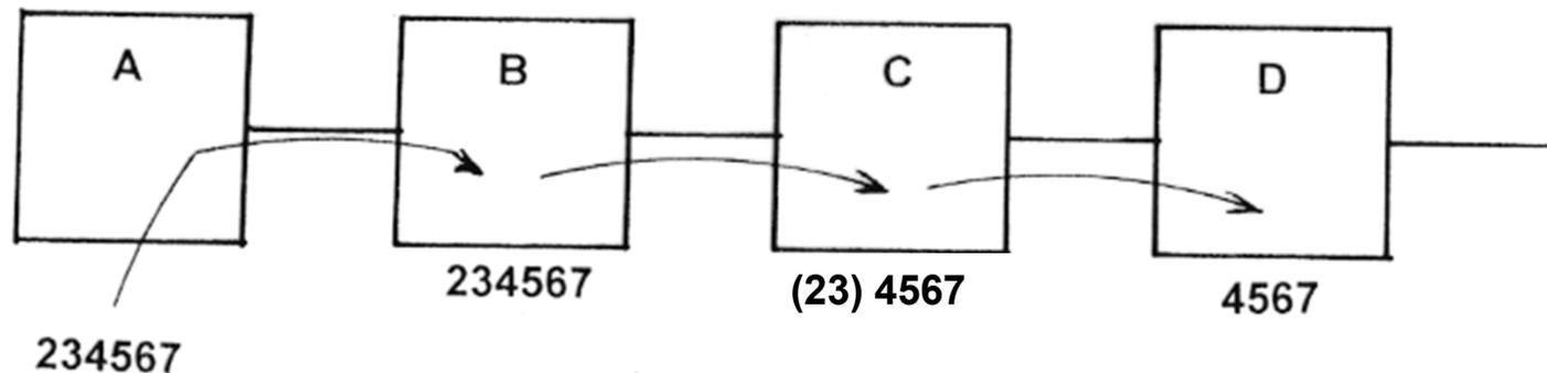
**Fig. 6 Señalización Extremo a Extremo**
