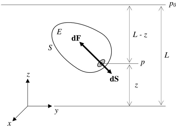
Si  $E$  es un sólido con superficie frontera  $S$  sumergido en un líquido de densidad constante  $\rho$ , en cuya interfase con la atmósfera reina una presión ambiente  $p_0$ , y si adoptamos un sistema de coordenadas como el de la figura, el principio de Pascal nos dice que la presión en el diferencial de superficie indicado, ubicado a una profundidad  $L - z$ , vendrá dada por:
