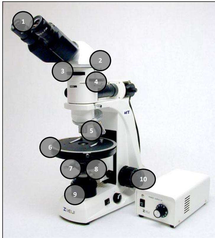
1. **Oculares:** Contiene un lente, normalmente de 10x (aumentos), a través del cual se observa la lámina delgada.
