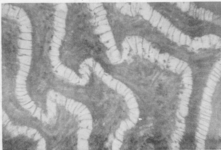
FIG. 13-10. ( \times 25 ) Remplazamiento de madera por ópalo con bandas contorneadas atribuidas a la etapa de gelatinización.
