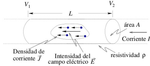
Figura 1: Esquema del transporte de la carga.
