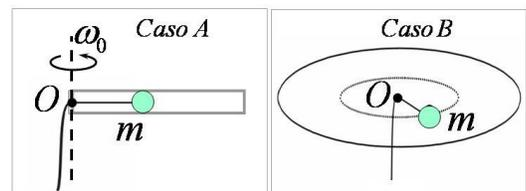
En el caso  $A$  la partícula está en el interior de un tubo que la obliga a rotar con velocidad angular constante  $\omega_0$ . En el caso  $B$  no existe dicho tubo. En la condición inicial, de ambos casos, la longitud de la cuerda es  $L$  y la velocidad angular de la partícula es  $\omega_0$ .
