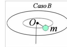
La tensión inicial es:  $T_i = mL\omega_0^2$ ; se duplica si  $T_f = 2T_i = 2mL\omega_0^2 = m\frac{L^4\omega_0^2}{r_f^3} \Rightarrow r_f = \frac{L}{\sqrt[3]{2}}$
