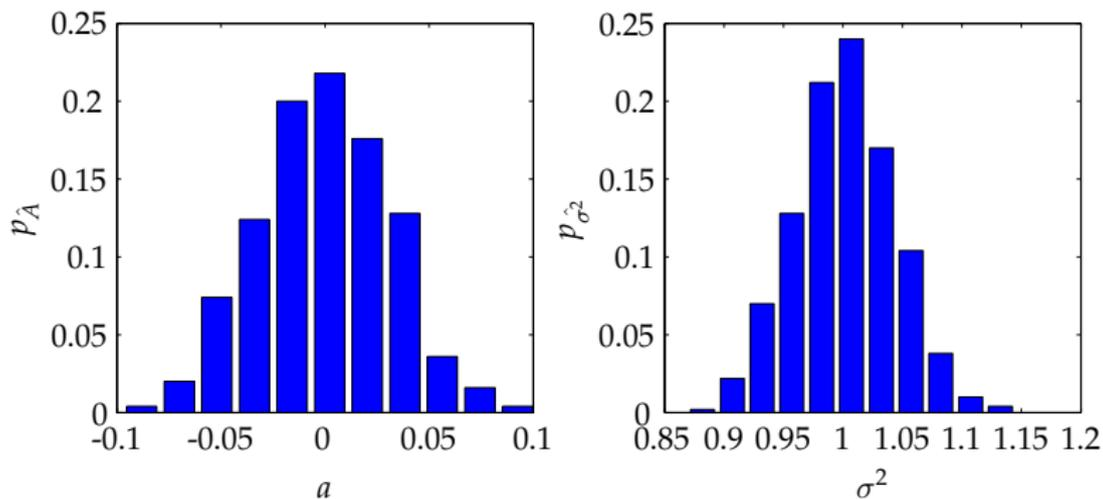
**Figura:** Distribución empírica (histograma) de los estimadores  $\hat{A}$  y  $\hat{\sigma}^2$  producidos via simulación con  $N = 1000$  y 500 simulaciones; los parámetros reales son  $A = 0$  y  $\sigma^2 = 1$ .
