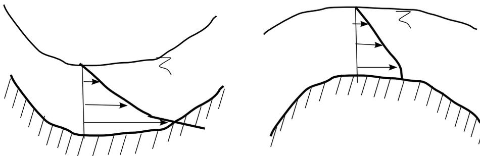
**Figura 3.9:** Distribución de presiones con curvatura de líneas de corriente.
