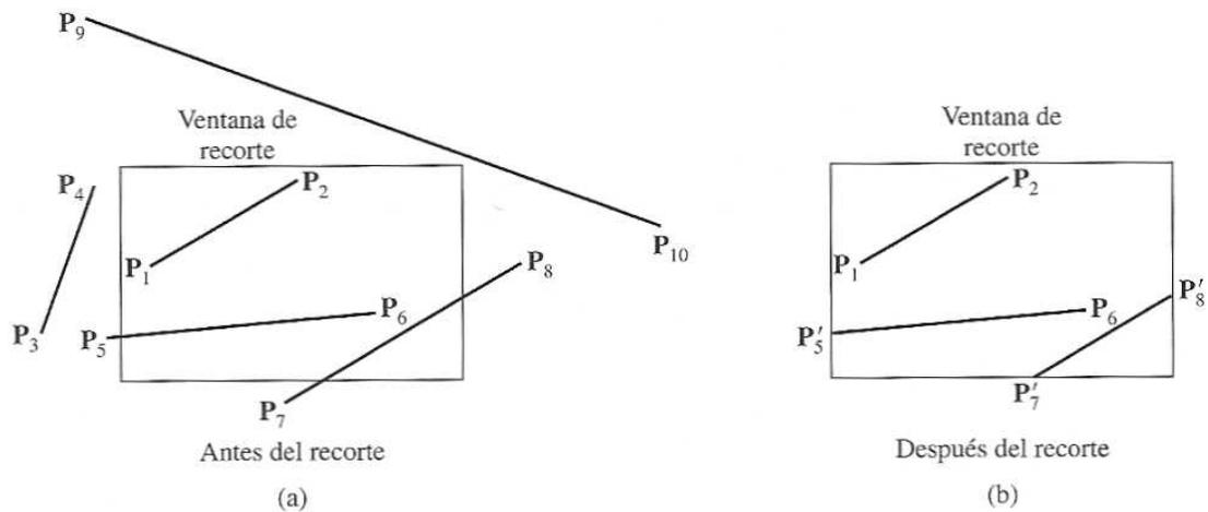
FIGURA 6.11. Recorte de segmentos de línea recta utilizando una ventana de recorte rectangular estándar.
