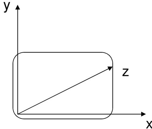
Obs: rotaciones positivas se mueven en sentido de los punteros del reloj miradas desde el eje positivo (son idénticas en ambos sistemas)
