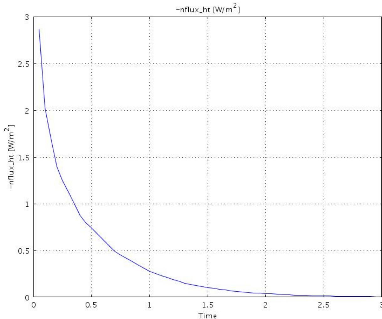
*Flujo de calor en el tiempo a través de superficie en  $x=0$*
