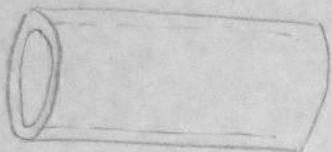
Volumen de control cilindro hueco de radio  $r + \Delta r$
