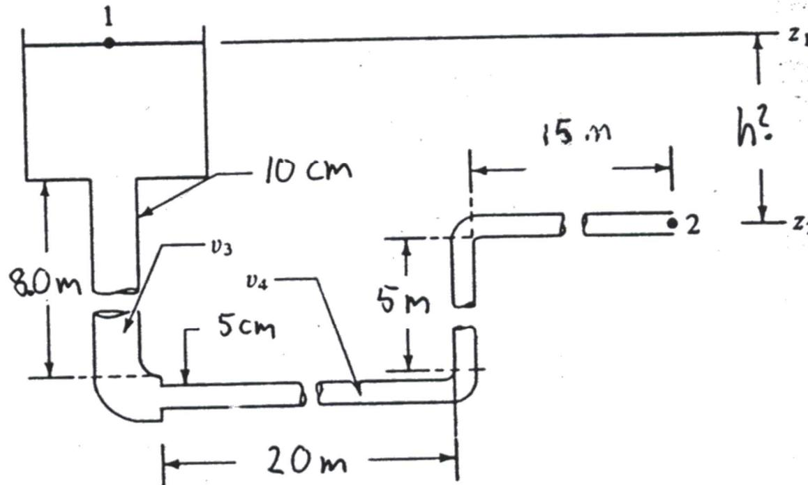
Un gran estanque almacena agua. El sistema de piping que conecta dicho estanque presenta longitudes y diámetros indicados en la figura y su material es de acero comercial. Considere,  $\rho_{\text{agua}} = 998 \text{ kg/m}^3$ ,  $\mu_{\text{agua}} = 10^{-3} \text{ Pa}\cdot\text{s}$ .
