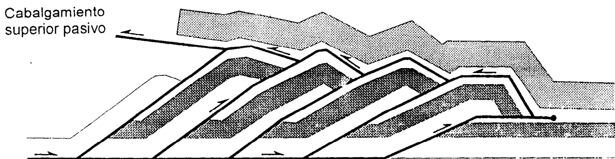
Figura 3.8: Sistema duplex de techo pasivo.
