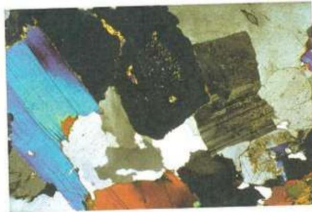
Fotografía A. Granitos con cuarzo, plagioclasa y micas
