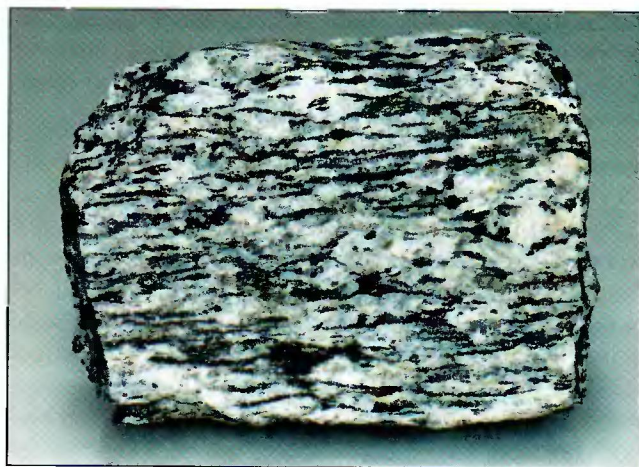
▲ Figura 8.7 Esta roca muestra una textura gnéica. Obsérvese que los granos oscuros de biotita y los silicatos claros están segregados, dando a la roca un aspecto bandedado o estratificado. (Foto de E. J. Tarbuck.)
