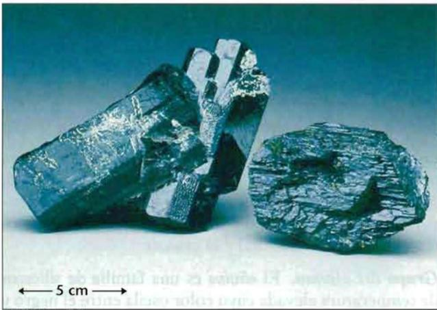
▲ **Figura 3.25** Anfíbol hornblenda. La hornblenda es un silicato común oscuro que tiene dos direcciones de exfoliación que se cortan a 60° y 120°.
