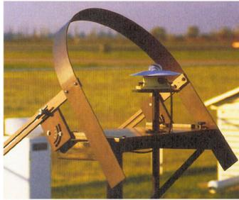
Figura 5: Piranómetro para medir radiación solar difusa.
