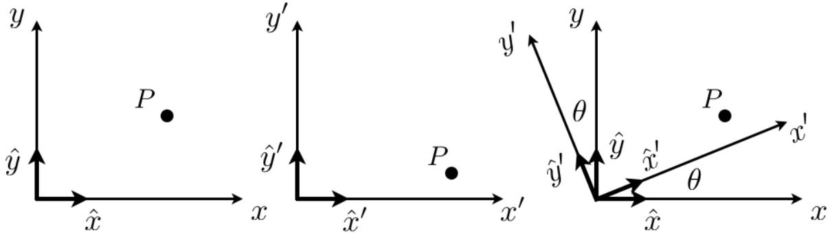
Figure 2: Ejemplo de una rotación sobre las coordenadas cartesianas.
